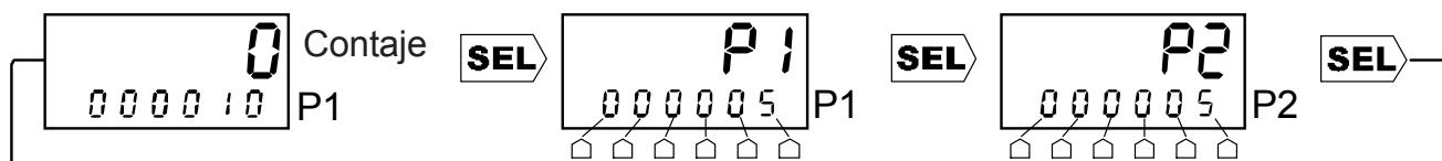
Presione SEL, luego use los botones de Dígitos para cambiar P1. El visualizador destellará. Presione SEL nuevamente para aceptar el nuevo valor P1, luego use los botones Dígitos para cambiar P2. Presione SEL nuevamente para aceptar el nuevo valor de P2. Si SEL no se presiona dentro de los 30 segundos del último cambio de P1 o P2, volverán a sus valores originales.
