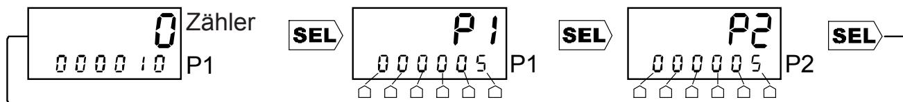
Drücken Sie SEL, und ändern Sie anschliessend P1 mit Hilfe der Zifferntasten. Daraufhin blinkt die Anzeige. Drücken Sie nochmals SEL, um den neuen Wert für P1 zu übernehmen, und ändern Sie anschliessend P2 mit Hilfe der Zifferntasten. Drücken Sie nochmals SEL, um den neuen Wert für P2 zu übernehmen. Wenn SEL nicht innerhalb von 30 Sekunden nach der letzten Änderung von P1 oder P2 gedrückt wird, gelten wieder die ursprünglichen Werte.
