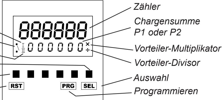
Die beiden Tasten auf der Frontblende dienen zum Programmieren des Zählers sowie zum Anzeigen und Einstellen der Vorwahlwerte P1 und P2. Alle Tasten können über den Tastensperren-Eingang deaktiviert werden (siehe „Programmierung“ auf S. 12).
