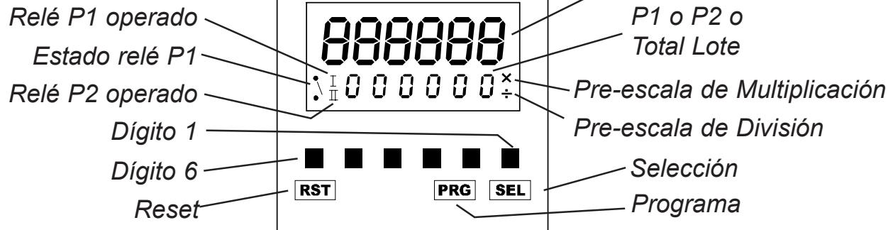
Los botones del panel frontal son utilizados para programar el contador y para visualizar y establecer los valores preselección P1 y P2. Todos los botones pueden ser deshabilitados mediante la entrada "Inhibición de Teclado". (ver Programación, página 24).
