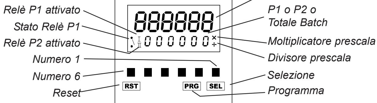
I pulsanti del pannello frontale sono utilizzati per programmare il contatore e per visualizzare e settare le preimpostazioni P1 e P2. Tutti i pulsanti possono essere disabilitati tramite l'ingresso di inibizione tastiera. (Vedi **Programmazione**, pagina 30).
