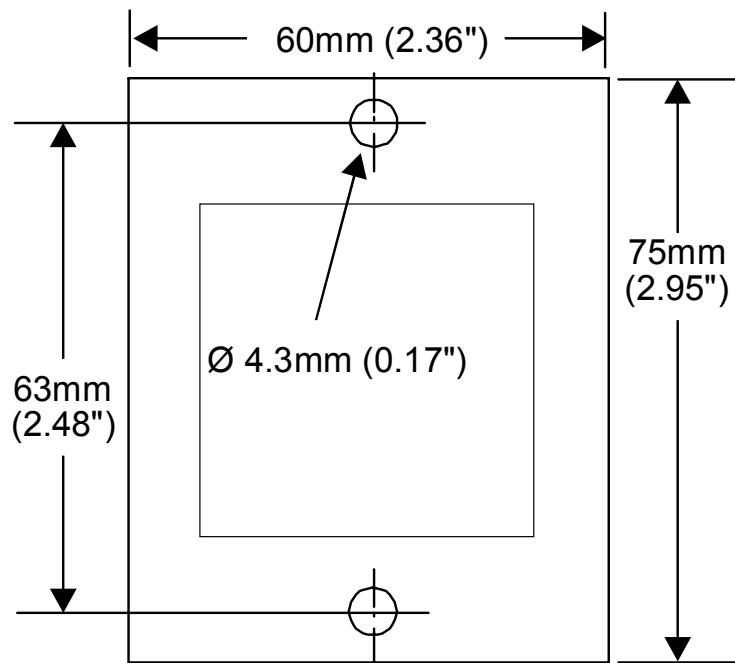
**Fixing Clip, Befestigungsclammer, Clip de fixation, Clip fijación, Fermaglio di fissaggio**
