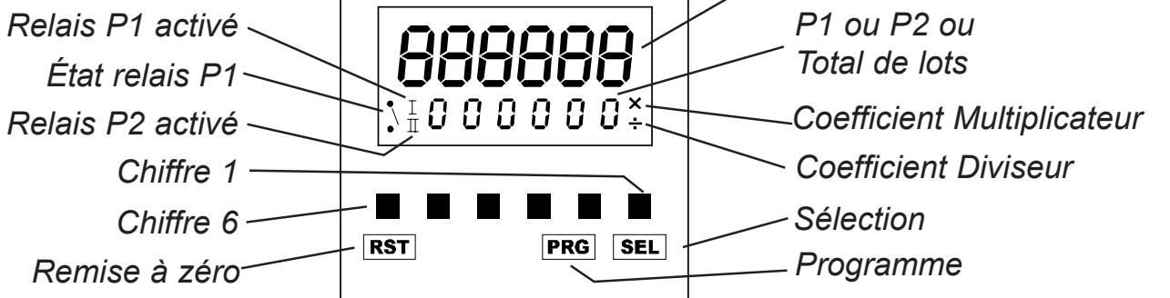
Les boutons du panneau de commande sont utilisés pour programmer le compteur ou bien pour afficher et déterminer les présélections P1 et P2. Tous ces boutons peuvent être invalidés à l'aide d'une entrée d'invalidation par clavier. (voir *Programmation*, page 18).
