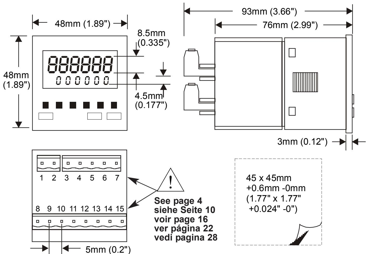
**Screw-fixed bezel, Frontrahmen mit Schraubenbefestigung, Cadre à vis, Marco fijado con tornillos, Cornice a vite**
