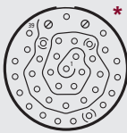
Disposition 20-39 37 contacts size/taille 20 2 contacts size/taille 16
