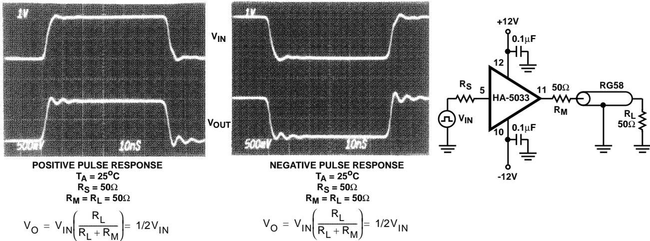
FIGURE 16. VIDEO COAXIAL LINE DRIVER - 50Ω SYSTEM
